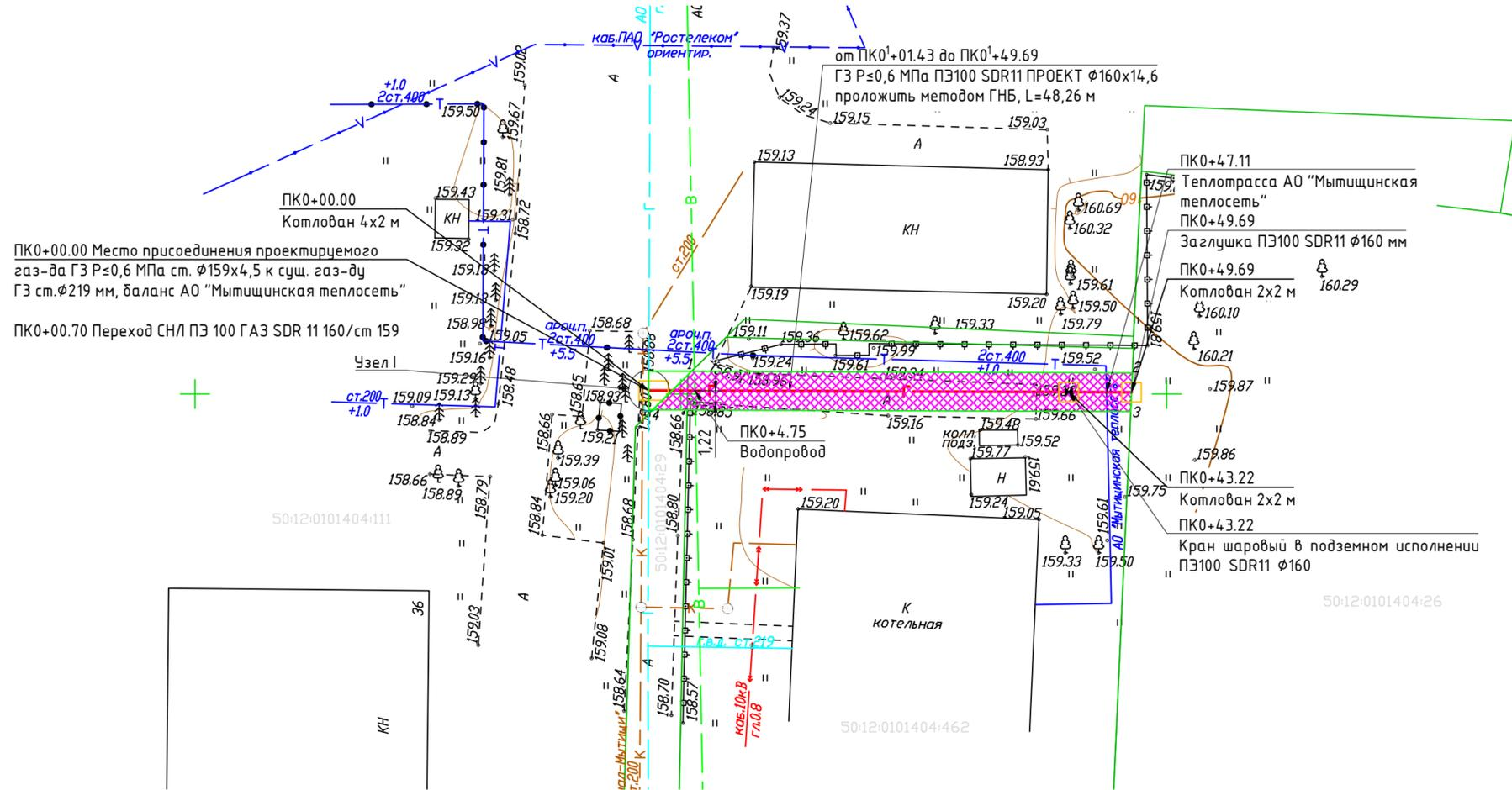
ПК0+00.00 Место присоединения проектируемого газ-да ГЗ P=0,6 МПа ст. ф159х4,5 к сущ. газ-ду ГЗ ст. ф219 мм, баланс АО "Мытищинская теплотрасса"
